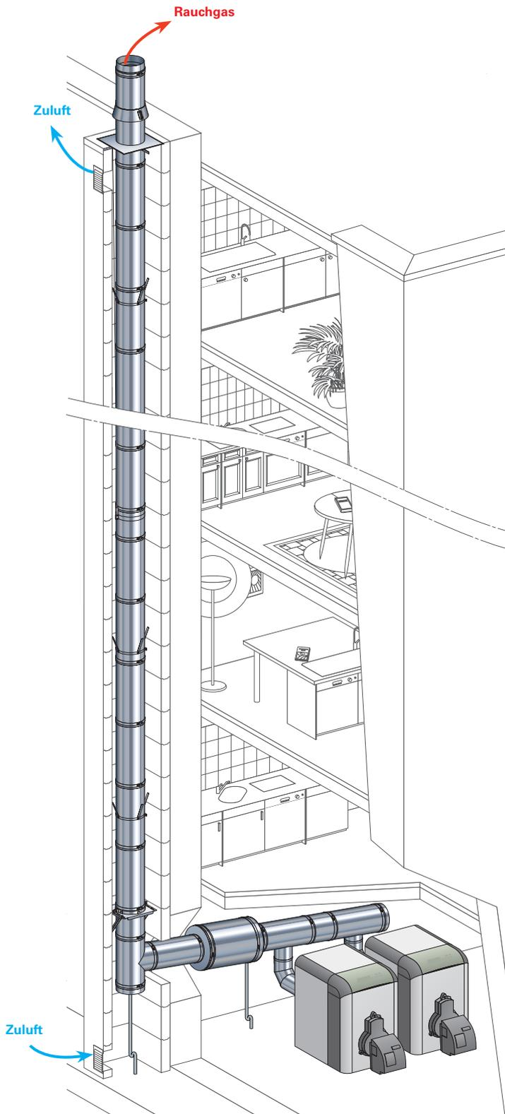
Das einwandige Rohrsystem CONDENSOR für verschiedene Brennstoffarten ist für Inneninstallationen zur Ableitung von Verbrennungsrückständen aller Heizkesseltypen bis 450 °C geeignet.
